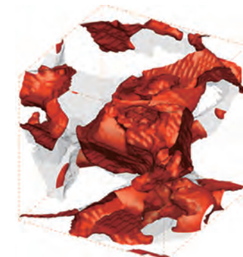
砂層孔隙内でのCO 2 ハイドレート生成シミュレーション Simulation of CO 2 hydrate formation within a pore space of sand grains
