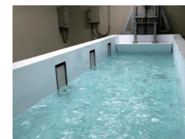
氷縁域再現水槽 (冷凍室内に設置された造波水槽) A wave-tank placed in a low-temperature room.
