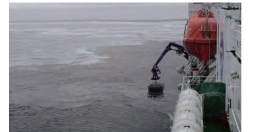
北極海におけるCTD/採水観測 (海洋地球研究船「みらい」2009年航海より) CTD/water sampling at 79N during R/V Mirai 2009 Arctic cruise
