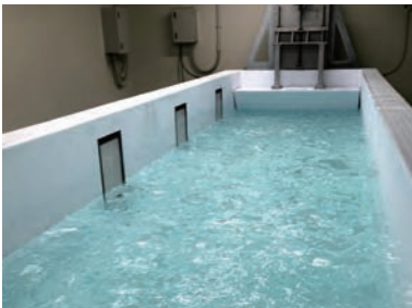
氷縁域再現水槽 (冷凍室内に設置された造波水槽)
