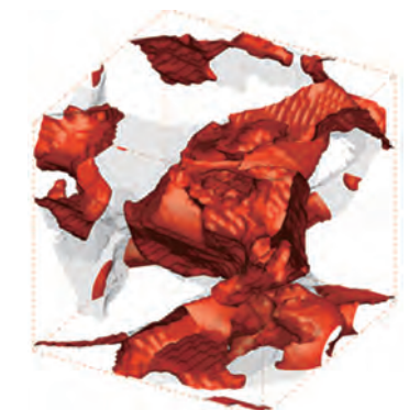
砂層孔隙内でのCO 2 ハイドレート生成シミュレーション Simulation of CO 2 hydrate formation within a pore space of sand grains
