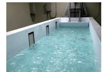
氷縁域再現水槽 (冷凍室内に設置された造波水槽) A wave-tank placed in a low-temperature room.
