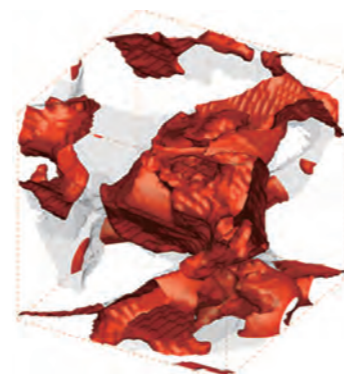
砂層孔隙内でのCO 2 ハイドレート生成シミュレーション Simulation of CO 2 hydrate formation within a pore space of sand grains
