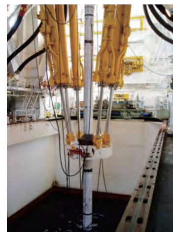
海洋底掘削のためのライザーテンショナー (JAMSTEC提供)
