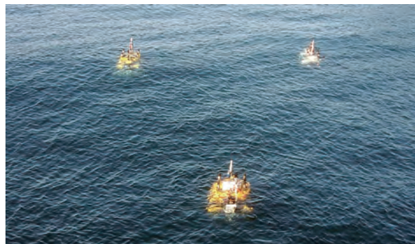
マルチビークル協調手法の海域試験に臨む3台のAUV (左からTri-TON, Tri-TON 2, Tri-Dog 1)
