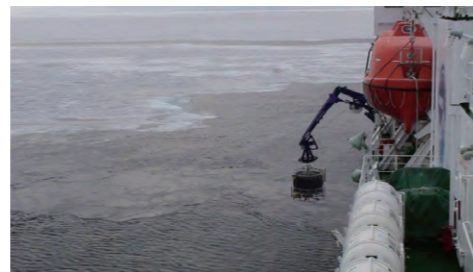
北極海におけるCTD/採水観測 (海洋地球研究船「みらい」2009年航海より) CTD/water sampling at 79N during R/V Mirai 2009 Arctic cruise
